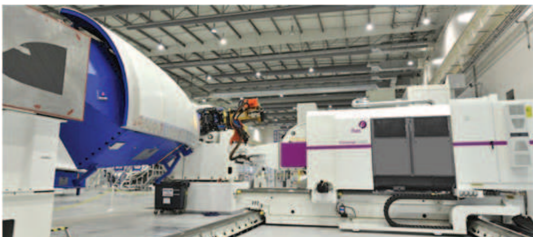
Рис. 4.1.1. Станок Cincinnati VIPER выкладывает деталь фюзеляжа
