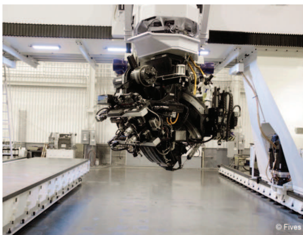
Рис. 4.1.7. Станок Cincinnati CHARGER™ и головка с резаком
